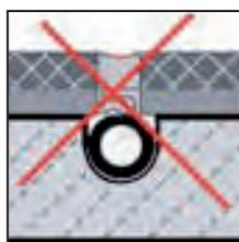
Les joints de dilatations et de fractionnement du bâtiment doivent être repris jusqu'au revêtement de sol. Les joints ne doivent pas se trouver au-dessus des génératrices supérieures des tubes.
